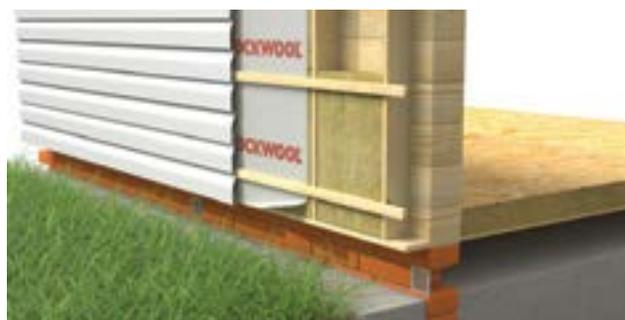
В конструкциях малоэтажных зданий с наружным утеплением
