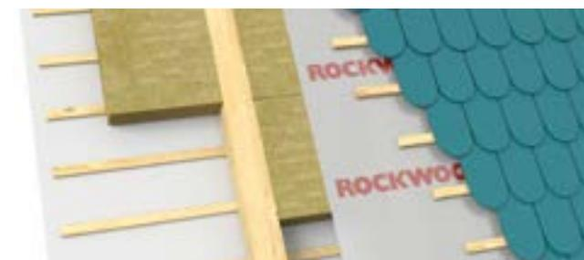
При монтаже утепленной кровли мембрана ROCKWOOL для КРОВЕЛЬ монтируется поверх утеплителя непосредственно под кровельным покрытием. При этом, между кровельным покрытием и мембраной необходимо предусмотреть вентилируемые зазоры до 5 см. Полотна мембраны нужно располагать горизонтально и внахлест с минимальным перекрытием по всем сторонам 15 см.
